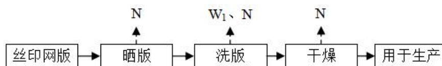
图 3-3 项目丝印网版制作工艺及产污环节流程图
